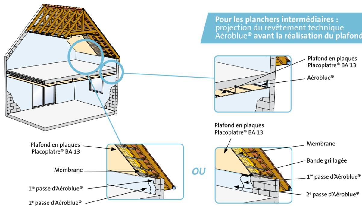
Pour les planchers intermédiaires : projection du revêtement technique Aérobblue® avant la réalisation du plafond
